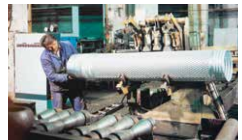
Herstellung eines Filterrohres Ø 368 mm, brüchekengeschlitzt und feuerverzinkt Zeitzeugen-Archiv
