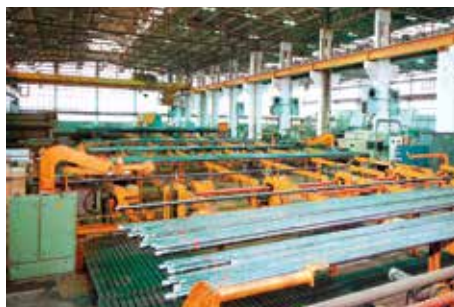
Fertigung von Steigrohren/Tubinge in der Produktionshalle 01.131 Zeitzeugen-Archiv
