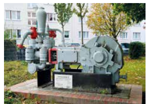
Hochdruckpumpe 9T für Erdöl-Erdgas-Bohrungen (bis 3000 m) Peggy Gerhard
