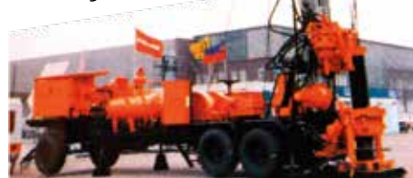
Flachbohrgerät KB 150 als Weiterentwicklung zum Typ MT 150 mit einer modernen Hochdruckhydraulik Zeitzeugen-Archiv
